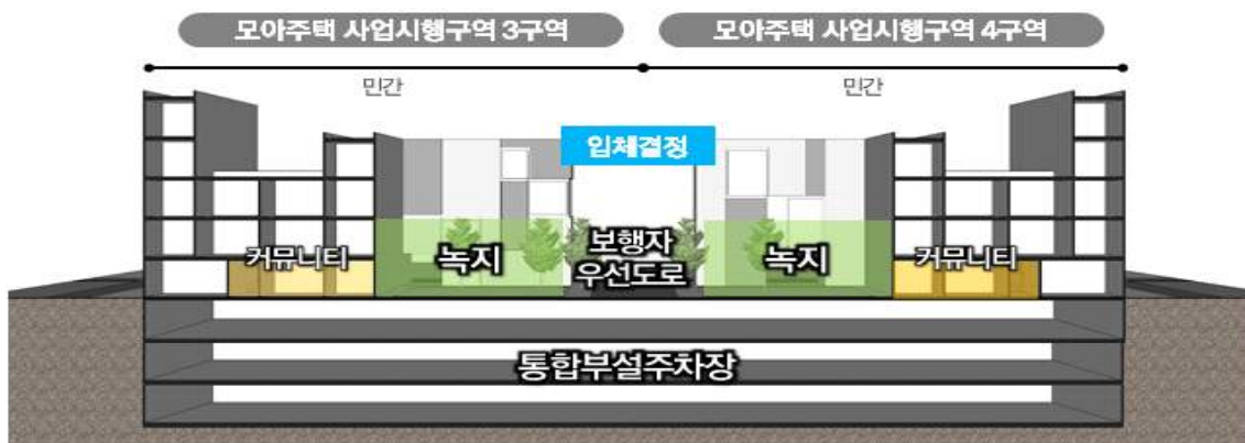
[그림-48] 통합 부설주차장 설치(안)_예시
