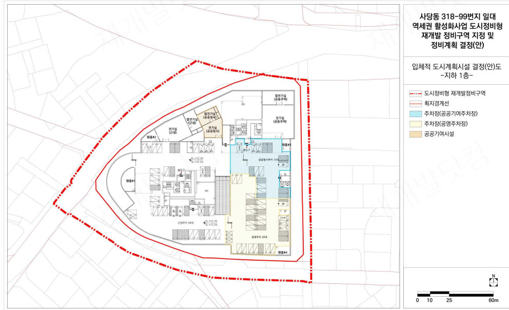
[도시계획시설 입체적결정(안)도 - 지하1층 평면도]
